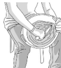
Aliste el agua ( limpia ) de amasado requerida según la cantidad de junta a preparar (ver tabla para dosificación de agua en el empaque). Adicione primero el agua y lentamente **ALFAQUICK JUNTA FINA CG2AW** mientras realiza el mezclado, mezcle hasta tener un producto homogéneo y libre de grumos, preferiblemente realizar mezclado mecánico, recomendamos el uso de un taladro eléctrico de 300 RPM para lograr mejores resultados.
